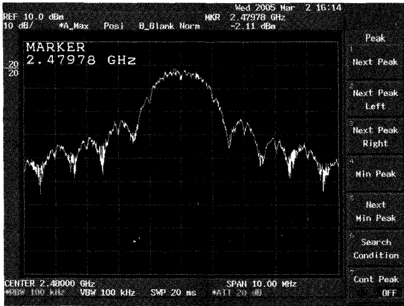
(그림 6) Ember사의 EM2420 RF칩을 사용한 모듈의 출력파형 측정
