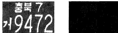
(a) 입력영상 (b) 가우시안 연산자를 이용한 에지 연산
