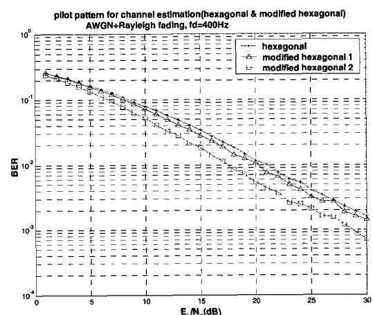
그림 7. Hexagonal 파일럿 패턴과 전이된 hexagonal 파일럿 패턴을 이용한 채널 추정 기법의 BER 성능 (AWGN+레일레이 페이딩, fd=400Hz)
