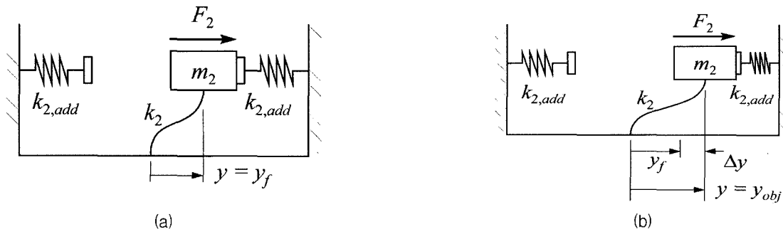
그림 9 RS-ATMD 입사의 경우 (a)TMD가 벽체 스프링을 접하는 순간( y = y_f ) (b)TMD의 속도가 0인 순간
