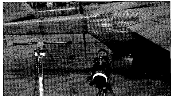
그림 16. Pro-spot을 이용한 항공기 Boom 측정
