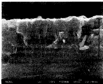
(b) V_{bias}=-25 V, 1.17 \mu\text{m}
