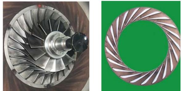
그림 9 APU용 원심압축기의 임펠러 및 디퓨저의 사진
