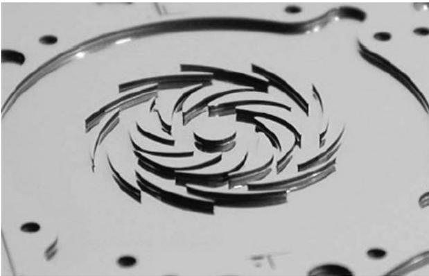
그림 2. MEMS 가스터빈엔진을 위하여 MIT에서 개발중인 초소형 원심압축기. 직경이 4~8mm이며 임펠러의 톱속도는 500m/s에 이른다.
