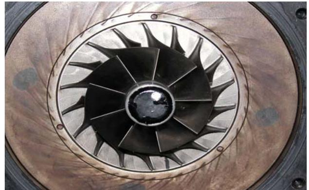
그림 11. UAV의 터보샤프트 엔진용 원심압축기의 임펠러 사진
