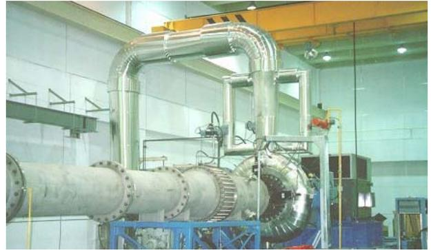
그림 8. 항우연이 보유하고 있는 2,300kW급 원심압축기 성능시험설비의 사진
