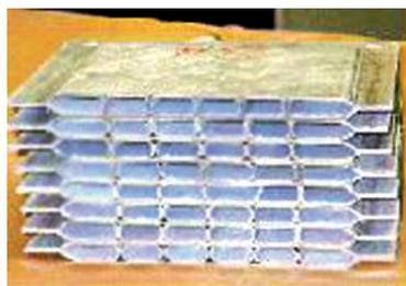
그림 10. Mass production of 8 SPF/DB sandwich panels
