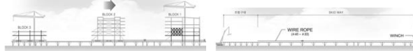
제4단계 : Block 1 상부조립, Block 2 이동 및 Block 3 조립 제8단계 : Block 4 · Block 5 접합 및 조립구대 해체
