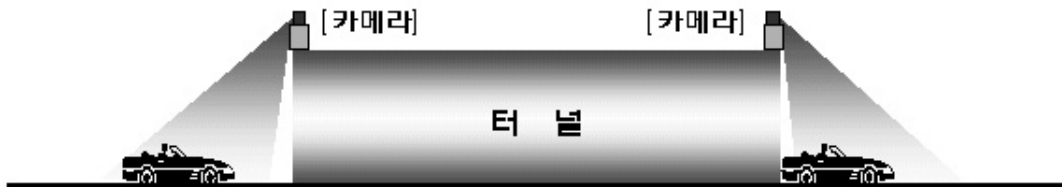
[그림 2] 터널부 촬영방법 및 조사지점 개념도
