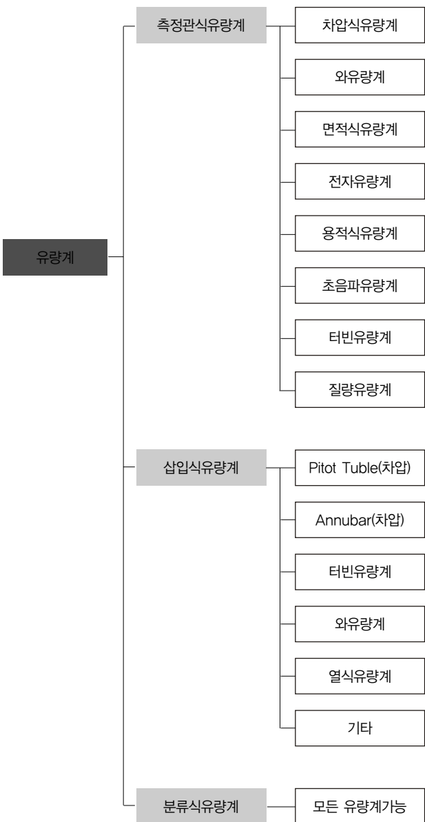
그림 1) 측정관식, 삽입식 및 분류식 유량계
