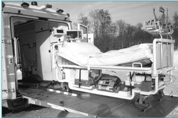
〈그림 2〉 독일의 중환자 이송용 구급차. 환자의 침대가 그대로 들어갈 수 있도록 되어 있으며, 환자 감시 장치가 머리 쪽에, 수액 주입 장치가 아래 쪽에 갖추어져 있다.
