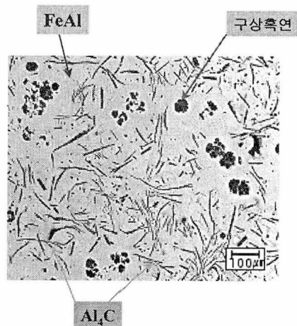
그림 3. 25wt%Al 구상흑연주철의 미세조직
