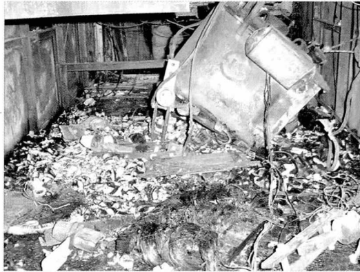
▲ MOF 수납함 안에 MOF 등이 소손되어 떨어져 있는 모습 ◀ 고열(600°C 이상)에 의해 검은 그을음이 완전 연소되어 하얗게 된 MOF 바로 위 천장 부분
