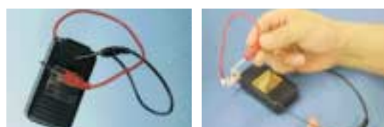
〈그림 21〉 Contact meter를 이용하여 전류 흐름 확인
