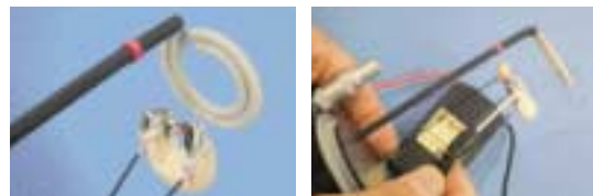
〈그림 23〉 Contact meter를 이용하여 Plating head와 모형과 전류 흐름 확인
