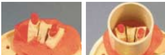
〈그림 10〉 Modeling을 작업모형 기저면에 고정한 다음 링을 위치
