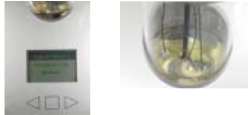
〈그림 28〉 30분간 활성화 단계를 거쳐 전기주조 작동 시작(6시간)
