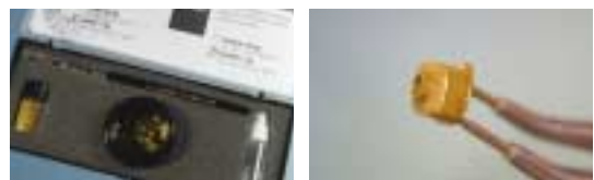
〈그림 14〉 22k gold bonder 도포
