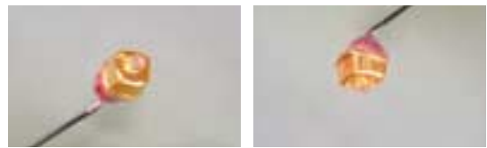
〈그림 10〉 Plating head에서 제거된 내관 코핑
