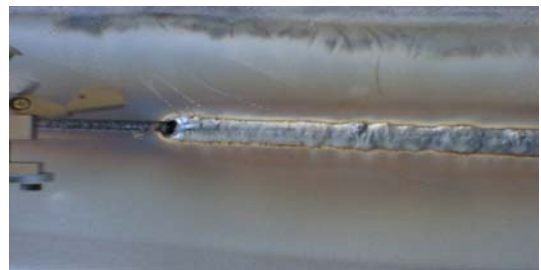
(d) 용접 전압 200V, 전류 400mA (d) Welding voltage : 200V, Welding current : 400mA
