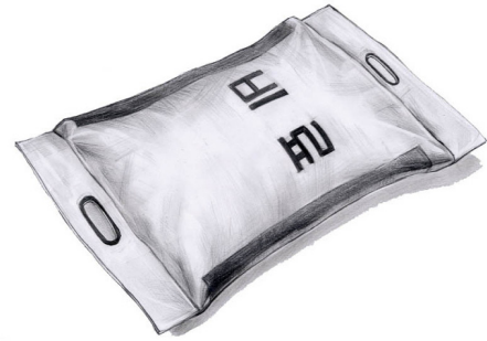
그림 1. 개발된 운반손잡이가 부착된 PP포대의 프로토타입.
