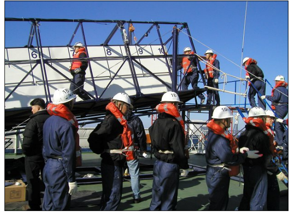
그림 4. 선박의 경사에 따른 승객의 개인이동 실험.
