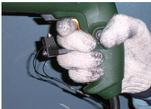
그림 7. 진동공구에 가속도계를 부착한 모습.
