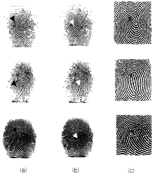
(a) (b) (c) 그림 3 중심점 추출 : (a) 후보 중심점 추출 (b) 중심점 추출 (c) 일정영역 분리
