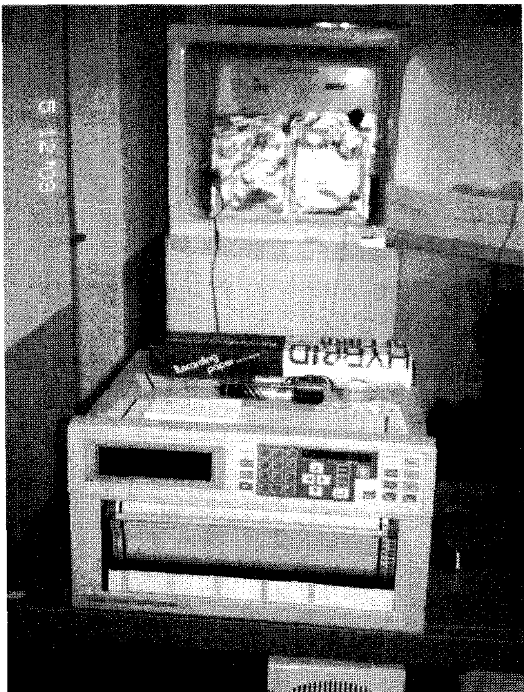
그림 1. 다점온도 기록계 및 냉각시스템
