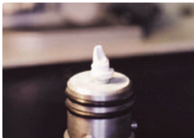
그림 4-7 Milling이 완성 된 Implant Abutment
