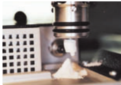
그림 4-6 Wol Ceram으로 Milling하는 과정
