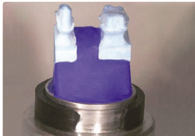
그림 3-2 Wol Ceram Chip을 위치하기 전 상태
