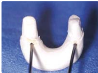
[ 그림 4 ] 주모형 실리콘 복제후 Electroforming die 제작(전기성형을 위한 wire 연결)
