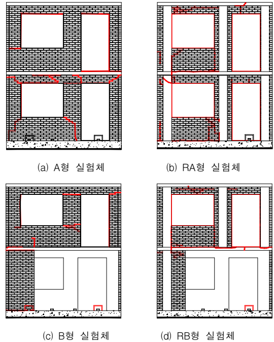
Fig. 3 벽체 W2의 균열 형상(최종단계)
