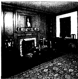
<그림 5> 한 면의 벽에 나무 패널을 설치하고 나머지 벽은 플라스터로 마감한 실내
