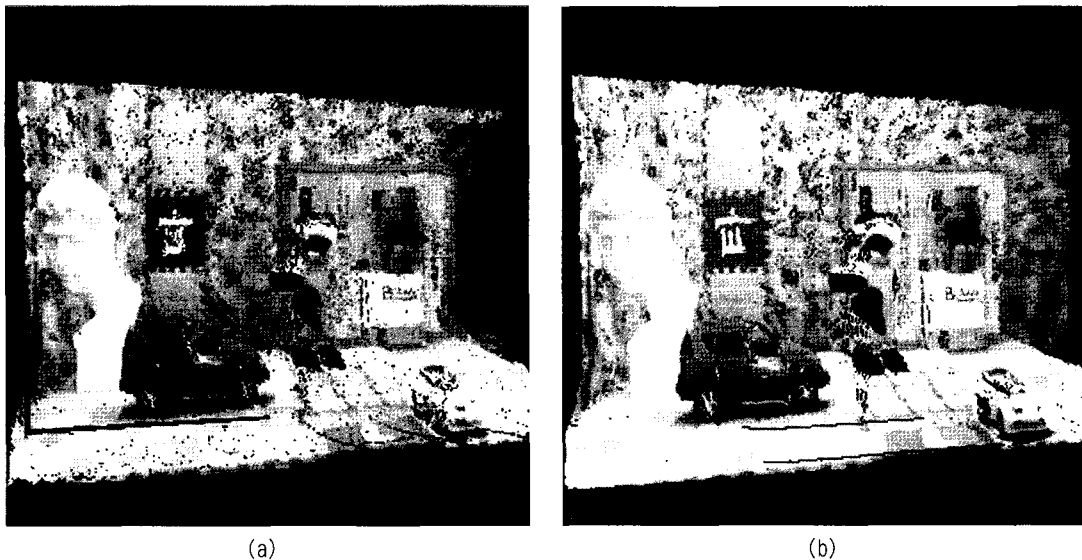
그림 8. 실험 영상 1에 대한 깊이정보 카메라 및 제안한 융합기법에 의한 깊이맵의 3차원 텍스처 투영 결과. (a)깊이정보 카메라 (b)제안한 융합기법 Fig. 8. 3D texture mapping results for depth maps for test image 1 by depth camera and proposed fusion method. (a)Depth camera (b)Proposed fusion method
