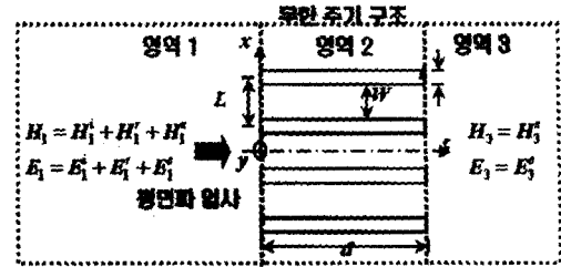
그림 2. 편파 변환기 설계를 위한 무한 주기 구조 Fig. 2. Infinite periodic structure for polarizer design.
