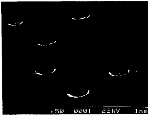
그림 7. 전기 화학 방전 가공된 유리 사진. Fig. 7. The SEM photograph of the machined glass.
