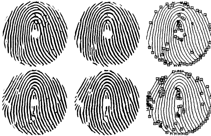
그림 10 그림 9의 두 지문 영상에 대한 최소합 영상, 이진 영상, 뼈대 영상, 그리고 끝점과 분기점(상: f0000033의 처리 영상들, 하: s0000043의 처리 영상들, □ - 끝점, ○ - 분기점)
