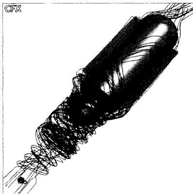
그림 10. 혈액펌프를 통과하는 streak line의 궤적 Fig. 10. Trace of the streak line passing the blood pump
