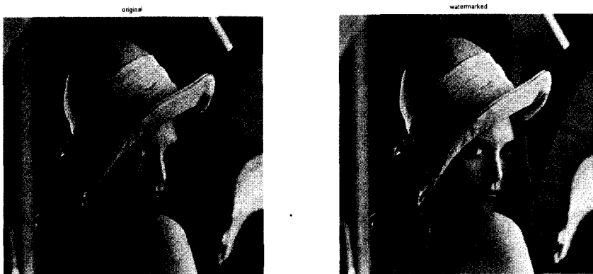
그림 5. 원본 영상(좌)과 워터마크가 삽입된 영상(우) (PSNR = 47.02) Fig. 5. Original image(left) and watermarked image(right) (PSNR = 47.02)
