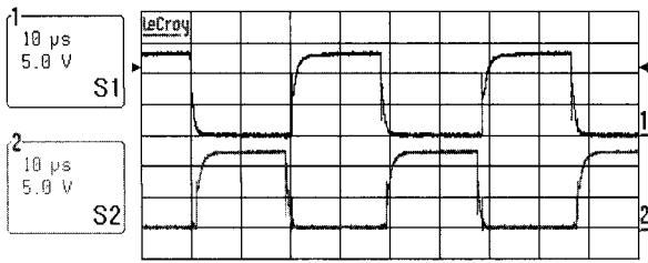
그림 7 하프-브릿지 스위칭패턴 Fig. 7 Switching pattern of half-bridge
