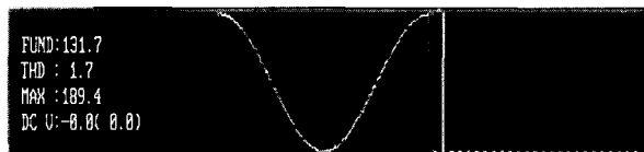
그림 11 정격 회생시 계통 주입 전류 및 THD Fig. 11 Output current and its THD in rated output
