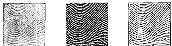
(a) 원본 지문 (b) 이진화 지문 (c) 세션화 지문 (그림 2) 이진화 및 세션화 결과 지문
