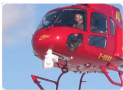
(a) Amphitech사의 OASysRadar 다중모드 레이더
