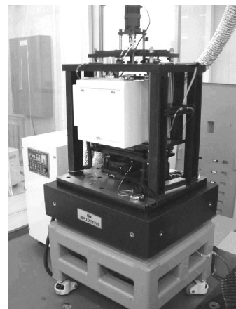
그림 16. UV 임프린팅에 기반한 나노패터닝 장비 시작품
