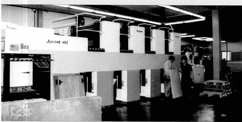
정하게 유지시켜줌으로써 인쇄기의 유지 및 관리가 용이하다. 또한 잉크롤러 항온 시스템을 장착하여 잉크롤러와 인쇄판면의 온도를 균일화함으로써 잉크 침윤량을 일정하게 유지시켜 주기 때문에 인쇄 품질 및 인쇄정밀도를 향상시켜 준다.
