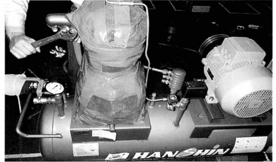
Fig. 11 공기 압축기 Lead Wrapping 시험.
