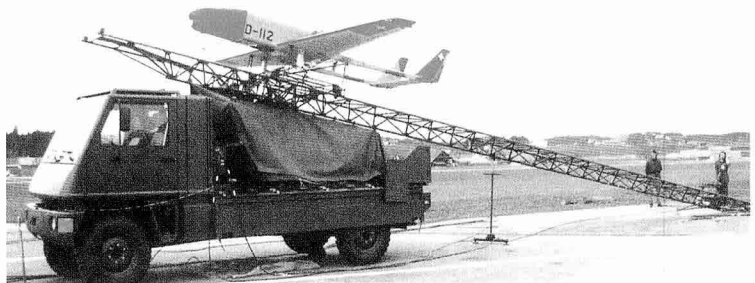
▲ 미국 Northrop Grumman사의 주도로 영국 WATCHKEEPER 사업을 위해 경쟁 중인 Ruag사 'RANGER' 무인항공기(스위스 육군용)
