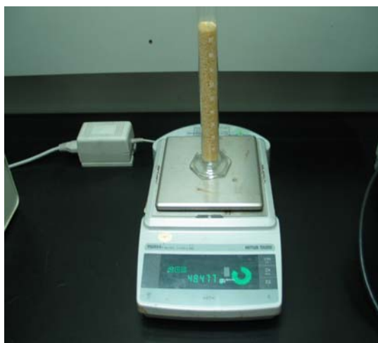
Fig. 3. 겉보기 밀도 측정 장비
