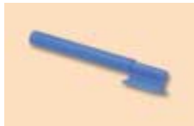
〈그림 4〉 플라스틱 패턴으로 제작된 male part
