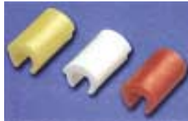
〈그림 4〉 플라스틱 패턴으로 제작된 male part
