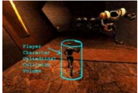
그림 1. 원기둥 모양의 볼륨으로 표현된 객체 Fig. 1. a cylinder model for the collision detection
