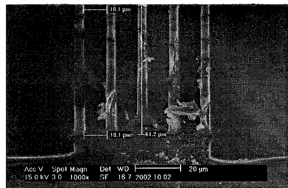
b) 식각속도 : 1.22 \mu m/min, Profile : 90°
