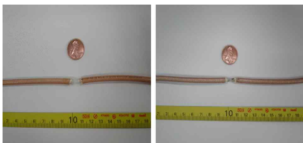
그림 6. RG 142 (a)와 RG 400 (b)의 손상된coaxial cable (손상 길이: 1cm).
