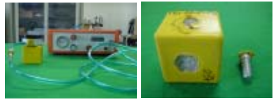
(a) Elcometer110 부착력 시험기로 수행중인 광경 (b) 돌리 탈착 후 광경
