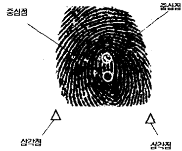
그림 6. 반도체식 센서로 획득한 지문영상과 특이점 Fig. 6. Captured fingerprint image and minutia using semiconductor sensor
