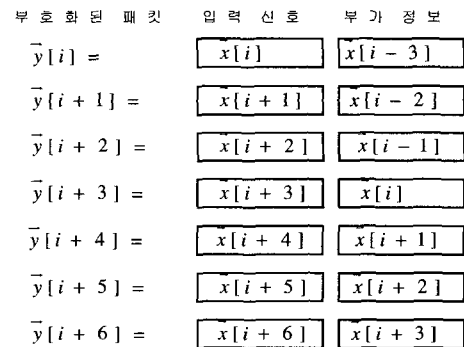
그림 5. 3 패킷 이전의 부가정보를 사용한 경우 Fig. 5. The case using additional data from 3 packets ago.
