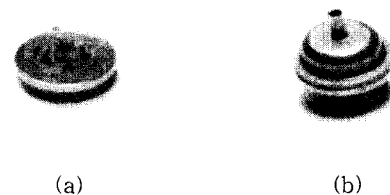
그림 3. To-5 패키징한 Ta-N 세라믹 박막형 압력센서의 (a) 내부 및 (b) 외부사진.
