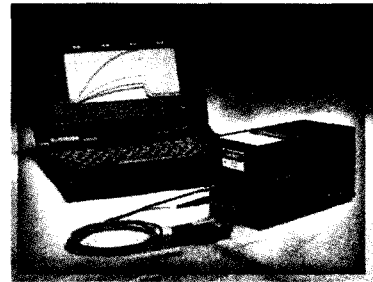
그림 13. 광섬유의 소산과 여기를 이용한 형광측정 센서시스템 (Research international Co. Analyte 2000)
